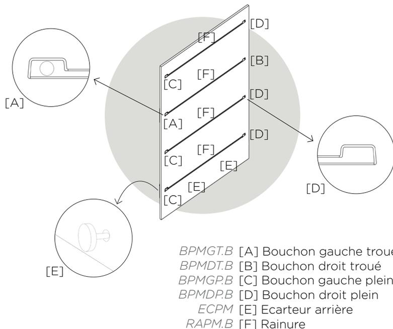
Les encoches latérales des panneaux muraux sont équipées de bouchons de protection (A, B, C et D sur le dessin ci-dessus).
