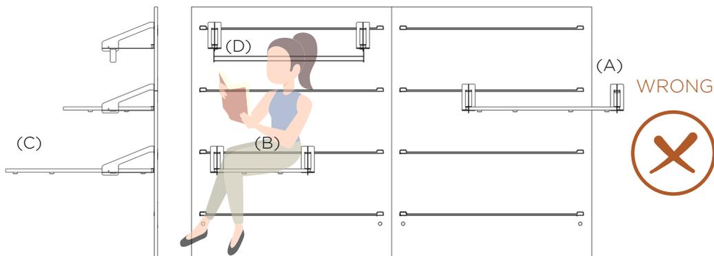
(A) Ne pas placer les consoles en dehors des rails, ni dans les encoches latérales.
