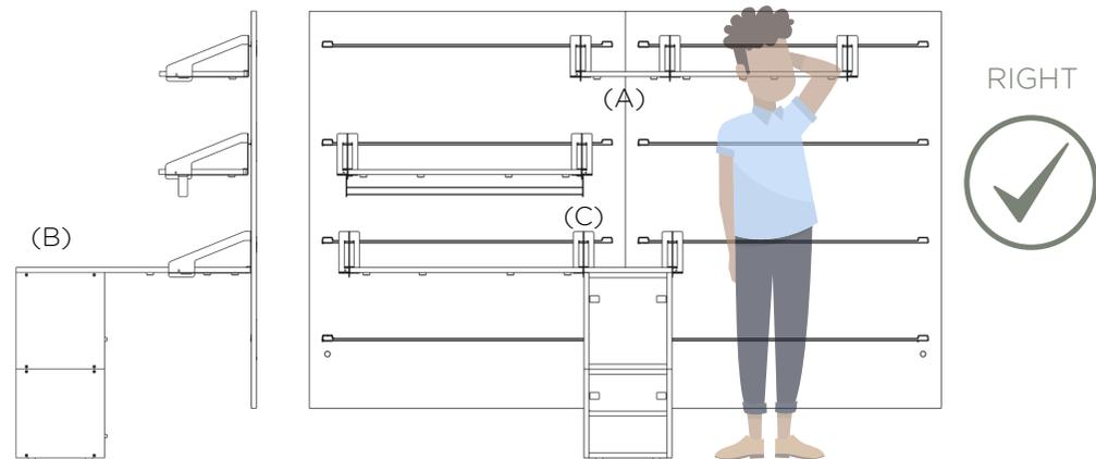
(A) Les consoles peuvent être à cheval sur deux panneaux, mais toujours dans la rainure (pas dans les encoches latérales).
